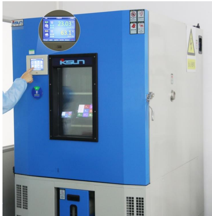
图 6-7 高低温老化测试图
